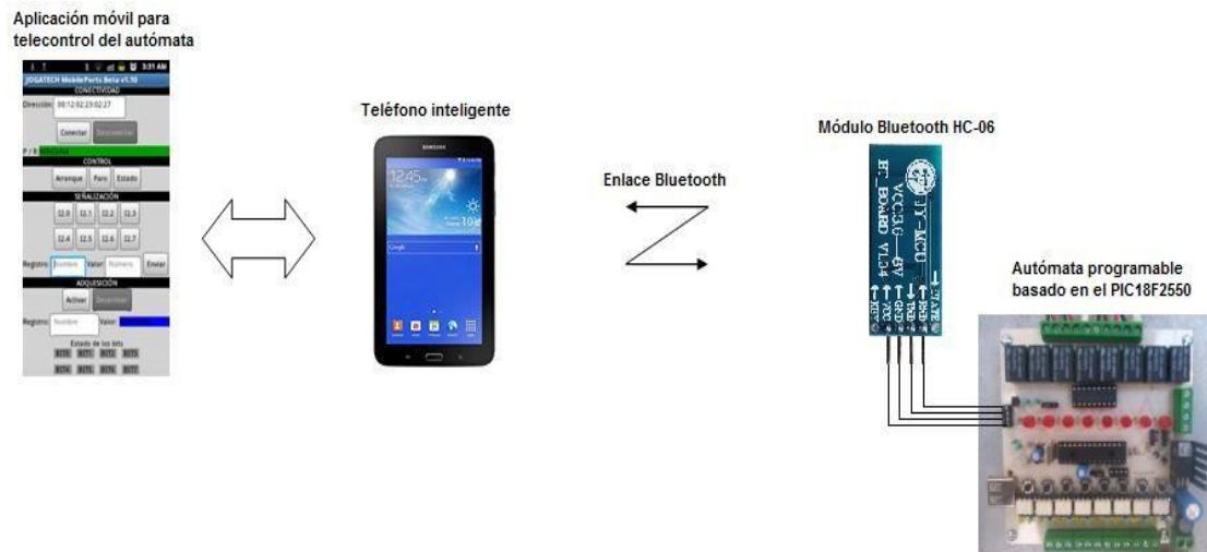
Figura 9 Utilización de la aplicación móvil como elemento de telecontrol del automata
